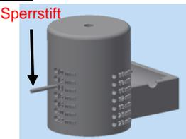
Je nach Länge der Antriebswelle Sperrstift in die Montagevorrichtung schieben
